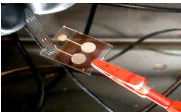
Prototype de cellule solaire organique à base de petites molécules. © Institut Moltech-Anjou (CNRS/Université d'Angers)
